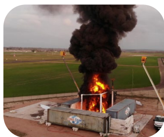
Incendie dû à des batteries au lithium
